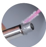
ワックス等、保護材の 除去をおこない、チタ ンベースの接着面に モノボンドプラスで処 理を行う
