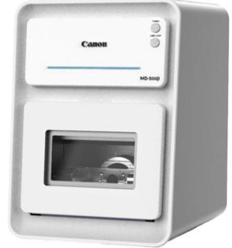
アイキャストから発売された“MD-500W”は、湿式専用のミリングマシンで、主に硬い材料であるチタンやガラスセラミックを切削することができます。日本国内のキャノン電子社製で設計・製造されており、独自の湿式加工パス技術により、高精度を維持しながら高速な切削が可能です。
