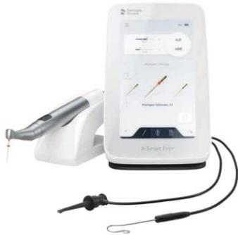
デンツプライシロナから発売された“X-スマート Pro プラス”は、多くの技術的、臨床的な改良が施され、最大 7.5N-cm のトルク、100~3,000rpm の回転速度により、全てのNiTi ファイルの操作が可能な EMR 付エンドモーターです。視認性に優れたタッチスクリーン・インターフェイスは操作がシンプルで、アップグレードが可能なファームウェアにより、将来のトリートメントにも対応が可能です。
