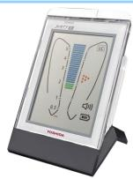
ヨシダから発売された"ジャスティⅣ"は、 独自の高精度測定で根尖までの距離を計 測する歯科用根管長測定器です。2 種類の 周波数の組み合わせから、常に整合性を確 認する「総合補足測定システム」を搭載。 口腔内の環境に影響されず、ドライでもウ ェットでも測定が可能です。
