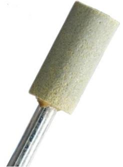
パントロンジャパンから発売された“モチールジルコダイヤポイント”は、セラミック（ジルコニア、プレスセラミックを含む）の切削に特化したダイヤモンド研削材です。粒子の異なるダイヤモンド砥粒を高密度に配合、さらにバインダー（結合材）として特殊セラミックによる成形されているため、研削後にセラミック表面にガスの発生の原因となる不純物が残らず、焼成時のトラブルを回避できます。また、切削効率が高く、局所的なフレームの発熱によるクラックも抑制します。
