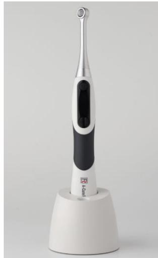
プレミアムプラスジャパンから発売された“A Cure Plus”は、最大光量 2,500mW/cm<sup>2</sup>により、1秒照射で2mmのレジンにスピード硬化することが可能な光重合器です。波長域は、385~515nmと広く様々な光重合材料に対応します。人間工学に基づいたホールドしやすいフォルムと極薄のライトヘッドで臼歯部への照射もスムーズに行えます。
