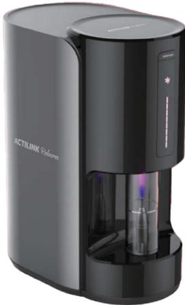
大栄歯科産業から発売された“アクティリンクリポーン”（韓国：Plasmapp 社製）は、歯科用金属の表面に対してプラズマ処理を行う装置です。歯科用インプラント材や歯科補綴における歯科用金属に対して60秒サイクルのプラズマ照射処理を行うことで、不純物を取り除き、対象物の接着性や親水性を高めることができます。アクティリンクリポーンはメーカーを問わず様々なインプラント材および上部構造、補綴などに利用が可能です。
