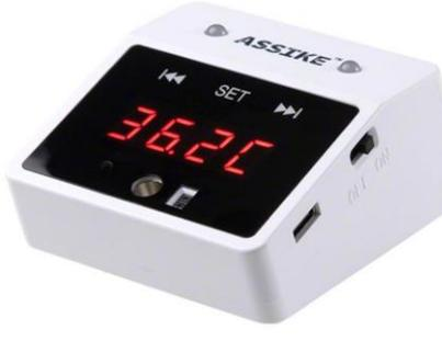
モモセ歯科商会から発売された“スグッピ”は手のひらを近づけるだけで体温を測定できる非接触体表面温度測定器です。わずか 0.5 秒の高速測定で、測定誤差は±0.2°C。ハンディ型の非接触型と比較して感染リスクと人件費を軽減します。
