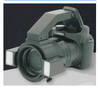
日本歯科商社から発売された"クリアファ イバーⅣ"(製造:セルフメディカル)は、 デジタルロ腔内撮影用光ファイバーユニ ットとパナソニック社製ルミックス (DC-FZ85) のデジタルカメラをセット にした歯科口腔内撮影用デジタルカメラ です。独自の光ファイバーにより、内臓フ ラッシュの光を効率よく均一に被写体へ と伝達し、鮮明な口腔内写真を撮影するこ とができます。
