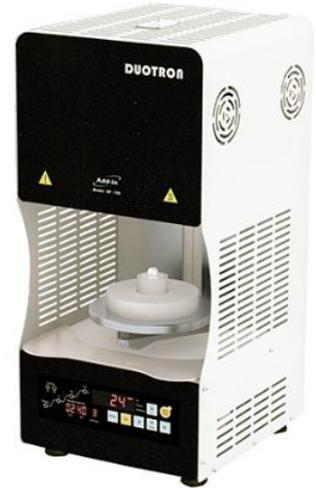
サンデンタルから発売されたジルコニア焼成用シタリングファーンレス“デュオトロンPRO SF-700”は、耐熱温度1,850℃の二酸化モリブデンヒーターを採用し、ジルコニア焼成時の熱線に十分な余裕をもたせながら焼成することが可能で、スケジュール通りの安定した温度管理を実現します。また、耐熱温度が高いことで、モリブデンの溶解による熱線の汚染がほとんどなく、均一な加熱・係留が可能です。
