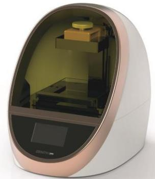
ヨシダから発売された“ゼニスD”は、DLPプリンティング技術を搭載し、複雑な形状も高速で作成が可能な3Dプリンターです。複雑な歯列の形態なども、再現することができ、また用途に応じて、積層ピッチを2段階（100μm、50μm）に切り替えられます。※積層ピッチは数字が大きいほど、作成時間が短くなります。上下顎フルアーチは積層ピッチ100μmの場合、約60分で作成できます。
